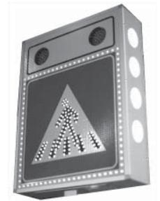
**modello interamente illuminato:** l'illuminazione di ogni faccia del segnale è ottenuta mediante nr. 360 led di tipo THT 5mm. con angolo di apertura 120°, disposti internamente lungo i 4 lati del segnale, tutte le sorgenti luminose sono gestite mediante segnale PVM in modo da modulare l'intensità luminosa al variare dell'illuminamento ambientale ed allo stato di carica della batteria.
