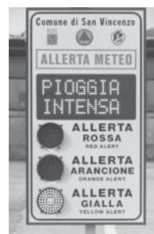
Le lampade a led e il display alfanumerico dovranno essere integrati in un pannello frontale in alluminio verniciato a polveri epossidiche di colore nero opaco per garantirne la massima visibilità, il resto del pannello dovrà essere a sfondo bianco e dovrà riportare informazioni supplementari (nome e logo dell'Ente responsabile, dicitura allerta meteo) e/o eventuali sponsorizzazioni.
