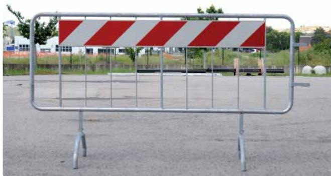
**Fig. 2402** dimensioni 110x200 cm., tubolare Ø 32 mm., con nr. 6 tondini Ø 8 mm., nr. 3 tubolari quadri 15x15 mm., applicato pannello rifrangente b/r cl.1 20x150 cm.
