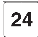
FIG. 261 ART. 129 SEGNALE DI PROGRESSIVA CHILOMETRICA
