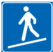
FIG. 308 ART. 135 RAMPA INCLINATA PEDONALE
