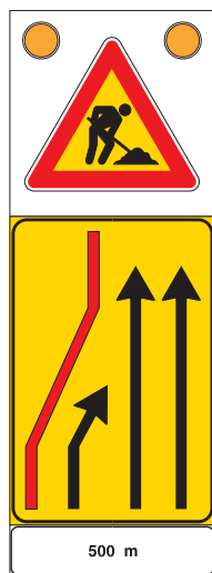
FIG. 399/a ART. 39 PRESEGNALE DI CANTIERE MOBILE CON LAMPEGGIATORI OMOLOGATI CL. L8H
