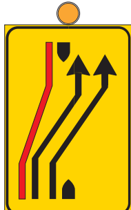
FIG. 413/c ART. 43 SEGNALE DI RIENTRO IN CARREGGIATA
