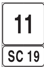
FIG. 268 ART. 129 PROGRESSIVA DISTANZIOMETRICA PER STRADA COMUNALE
