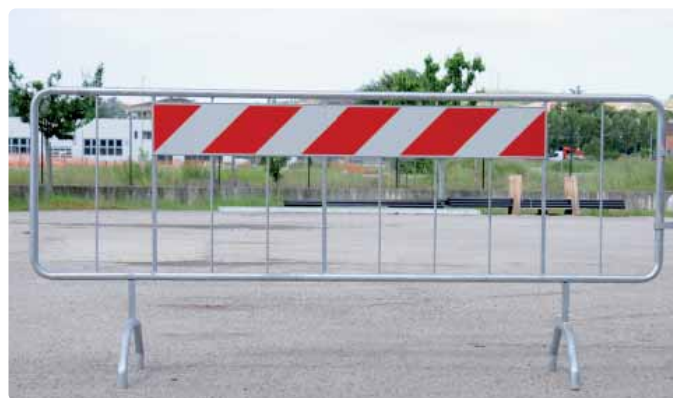
Fig. 2403 dimensioni 110x250 cm., tubolare Ø 32 mm., con nr. 7 tondini Ø 8 mm., nr. 3 tubolari quadri 15x15 mm., applicato pannello rifrangente b/r cl.1 20x150 cm.
