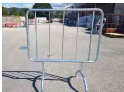
Fig. 3995 dimensioni 110x100 cm., tubolare Ø 32 mm., con nr. 2 tondini Ø 8 mm., nr. 3 tubolari quadri 15x15 mm., per eventuale applicazione pannello rifrangente b/r Fig. 3996 dimensioni 110x100 cm., tubolare Ø 32 mm., con nr. 2 tondini Ø 8 mm., nr. 3 tubolari quadri 15x15 mm., applicato pannello rifrangente b/r cl.1 20x75 cm.
