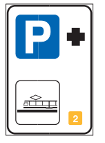
FIG.370 ART.136 PARCHEGGIO DI SCAMBIO CON METROPOLITANE OD ALTRI SERVIZI EXTRAURBANI SU ROTAIA
