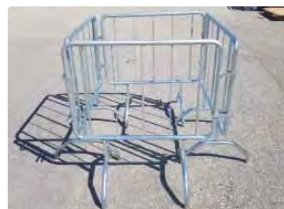
Fig. 3995 dimensioni 110x100 cm., tubolare Ø 32 mm., con nr. 2 tondini Ø 8 mm., nr. 3 tubolari quadri 15x15 mm., per eventuale applicazione pannello rifrangente b/r Fig. 3996 dimensioni 110x100 cm., tubolare Ø 32 mm., con nr. 2 tondini Ø 8 mm., nr. 3 tubolari quadri 15x15 mm., applicato pannello rifrangente b/r cl.1 20x75 cm.
