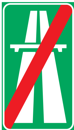
FIG. 346 ART. 135 FINE AUTOSTRADA (colore di fondo verde) FINE STRADA EXTRAURBANA PRINCIPALE (colore di fondo blu)
