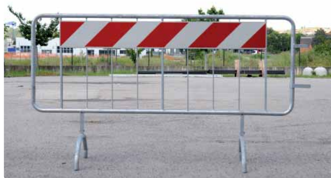
Fig. 2402 dimensioni 110x200 cm., tubolare Ø 32 mm., con nr. 6 tondini Ø 8 mm., nr. 3 tubolari quadri 15x15 mm., applicato pannello rifrangente b/r cl.1 20x150 cm.
