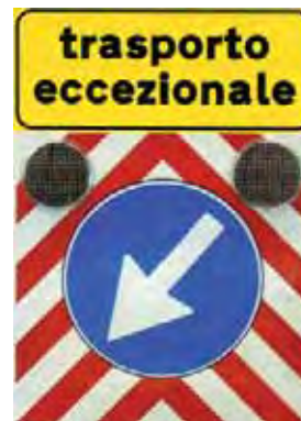
Targa scatolata in alluminio o lamiera, dimensioni 90x135 cm. pellicola rifrangente cl.2 prismatica, lampade led M200 lampeggianti gialle omologate cl. L8H e certificate "CE", freccia orientabile.
