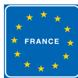
FIG. 97/b ART. 123 PREAVVISO DI CONFINE DI STATO TRA PAESI DELLA COMUNITA EUROPEA
