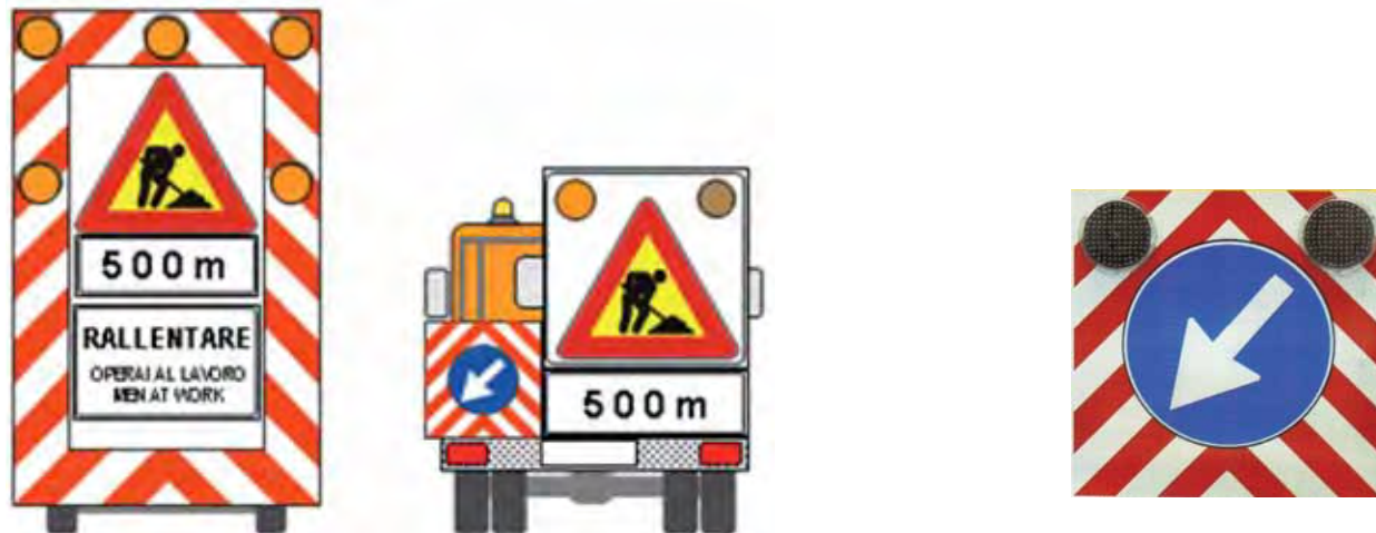
Esempi di presegnalazione di cantiere mobile in corsia di emergenza, il pannello segnaletico con appendice distanziometrica deve in ogni caso contenere un triangolo “lavori in corso” con lato 120 cm. e, nel caso dell’autocarro, essere integrato con lampade led M200 gialle omologate cl. L8H e certificate “CE” ad elevata efficienza
