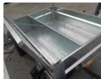
Vano porta batteria
