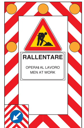
FIG. 1 ART. 39 PRESEGNALIZZAZIONE OPERAI AL LAVORO
