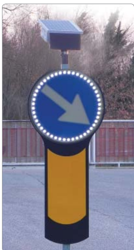
mm. 350x1400 disco Ø 600 "CG10" luminoso fig. 82 o 83 C.d.S. pannello fotovoltaico palo PVC 50x50x2000
