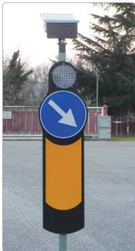
mm. 350x1430 con lampada M200 pannello fotovoltaico disco Ø 400 rifr. cl.2S fig. 82 o 83 C.d.S. palo PVC 50x50x2000
