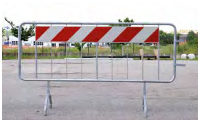
Fig. 2402 dimensioni 110x200 cm., tubolare Ø 32 mm., con nr. 6 tondini Ø 8 mm., nr. 3 tubolari quadri 15x15 mm., applicato pannello rifrangente b/r cl.1 20x150 cm.
