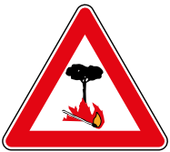
FIG. 34 ART. 102 PERICOLO DI INCENDIO
