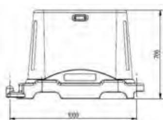
Fig. 2868 New jersey rosso impilabile con pellicola gialla rifr. cl.2 ambo i lati
