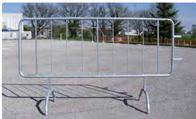
Fig. 2400 dimensioni 110x200 cm., tubolare Ø 32 mm., con nr. 6 tondini Ø 8 mm., nr. 3 tubolari quadri 15x15 mm., per eventuale applicazione pannello rifrangente b/r cl.1 20x150 cm.
