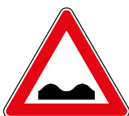
FIG. 1 ART. 85 STRADA DEFORMATA
