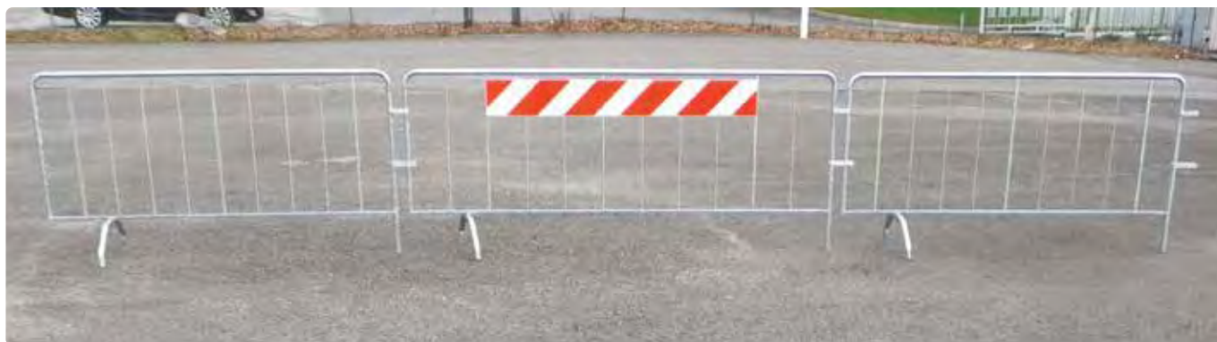
Fig. 2400/M dimensioni 100x200 cm., tubolare Ø 32 mm., con nr. 6 tondini Ø 8 mm., nr. 3 tubolari quadri 15x15 mm., per eventuale applicazione pannello rifrangente b/r cl.1 20x150 cm.
