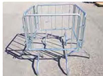
Fig. 3995 dimensioni 110x100 cm., tubolare Ø 32 mm., con nr. 2 tondini Ø 8 mm., nr. 3 tubolari quadri 15x15 mm., per eventuale applicazione pannello rifrangente b/r
