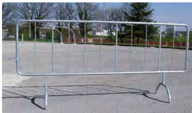
Fig. 2401 dimensioni 110x250 cm., tubolare Ø 32 mm., con nr. 7 tondini Ø 8 mm., nr. 3 tubolari quadri 15x15 mm., per eventuale applicazione pannello rifrangente b/r cl.1 20x150 cm.
