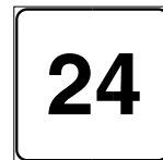
FIG. 261 ART. 129 SEGNALE DI PROGRESSIVA CHILOMETRICA
