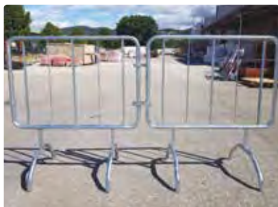
Fig. 3995 dimensioni 110x100 cm., tubolare Ø 32 mm., con nr. 2 tondini Ø 8 mm., nr. 3 tubolari quadri 15x15 mm., per eventuale applicazione pannello rifrangente b/r
