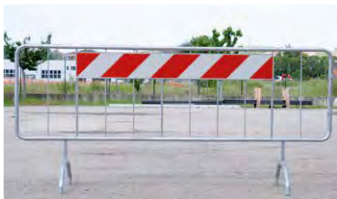
Fig. 2403 dimensioni 110x250 cm., tubolare Ø 32 mm., con nr. 7 tondini Ø 8 mm., nr. 3 tubolari quadri 15x15 mm., applicato pannello rifrangente b/r cl.1 20x150 cm.
